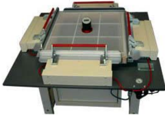
الشكل 13: آلة شد نسيج النخل على إطار النخل.
